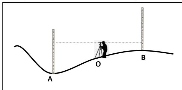
Nesse levantamento, a cota do ponto O vale 124,21 m, a altura do instrumento é de 1,52 m, a diferença de nível entre os pontos A e B é de 1,44 m e a leitura na régua situada no ponto B foi de 0,74 m. Desta forma, a cota do ponto B e a leitura na régua situada no ponto A valem, respectivamente:
